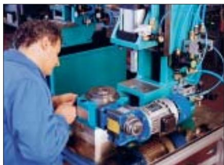
Tutte le tavole meccaniche G.P.A. possono essere abbinate alle presse pneumatiche ed idropneumatiche G.P.A. per creare sistemi ad alta cadenza di lavoro, come nelle foto seguenti dove sono mostrate macchine con presse da 20 a 70 kN.
